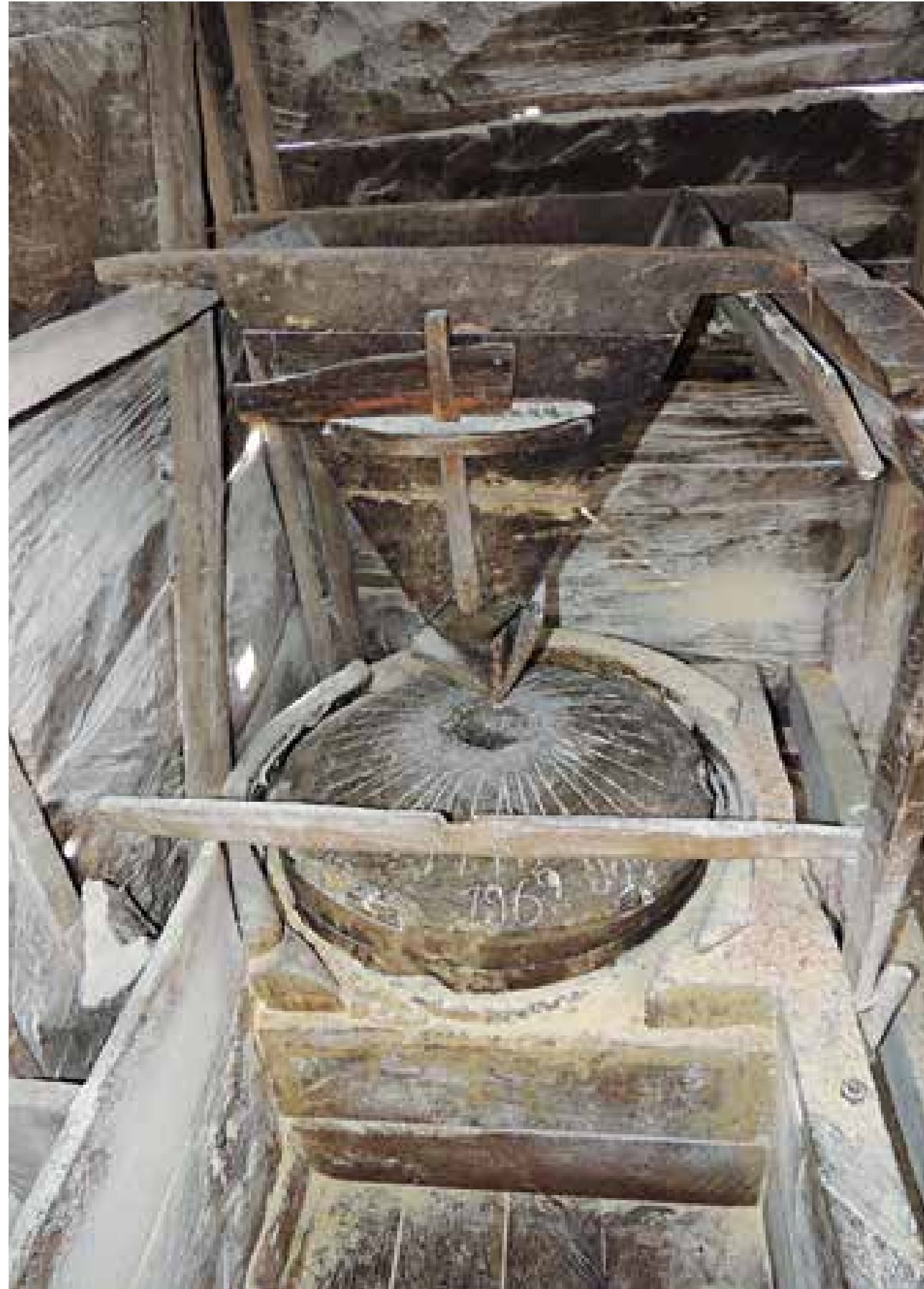
Unutrašnjost mlina u Johovici. Na fotografiji jasno se vidi i drvena konstrukcija oko gornjeg žrvnja, u narodu zvana okolišaj. U novije vrijeme oblaže se i limom. Služi da sakupi brašno ispod žrvnja i usmjeri ga u drveni sanduk ili kupac.
