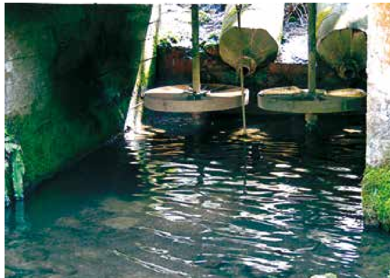
Iz dva snažna metalna badnja, dva mlaza pokreću dva mlinska kamena.
