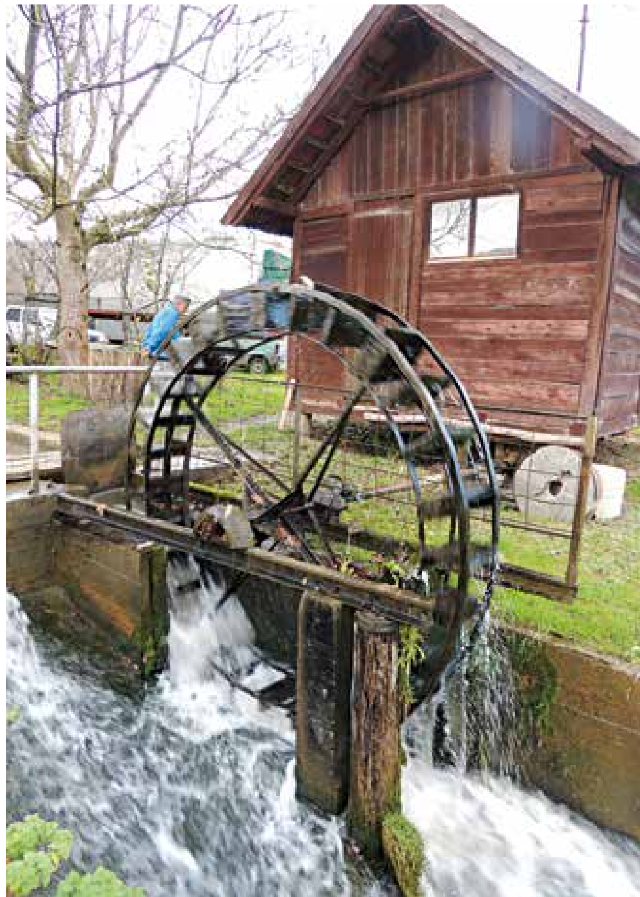
Vodenica u Ljeskarama kod Prijedora, u zaseoku Dubočaj, izgrađena još 1936. godine na rječici Ljubijica. Braća Radočaj obnovili je prije desetak godina i danas svakodnevno melje žito. (Vertikalno mlinsko kolo tipa podljevača na koje voda s donje strane udara u lopatice i pokreće ga).
