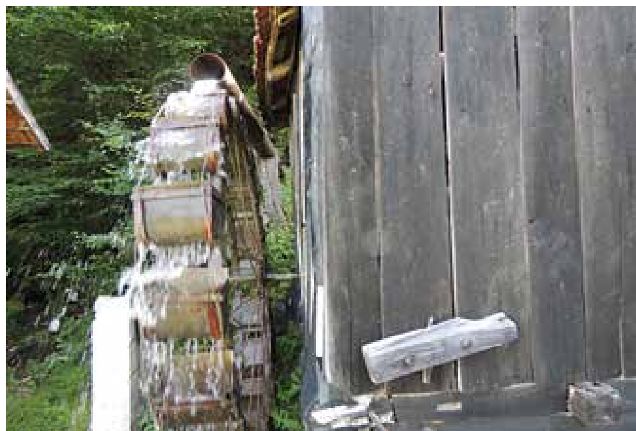
Mlin Milana Miljuša ima drugi tip vertikalnog mlinskog kola, zovu ga nadljevača, jer voda sa gornje strane puni kašike (poluzatvorene kofe) i tako okreće mlinsko kolo.
