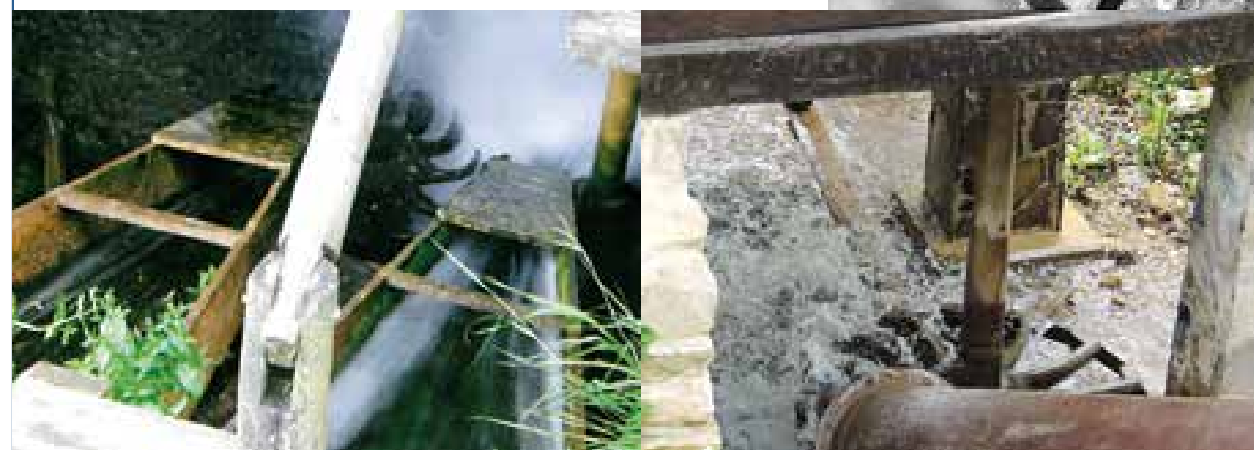
Kroz žljeb ili badanj, ili preko lopatica vertikalnog točka, voda, kada se podigne ustava, teče što većim mlazom i preko prenosnog mehanizma, vitla, zupčanika i vretena pokreće žrvanj.
