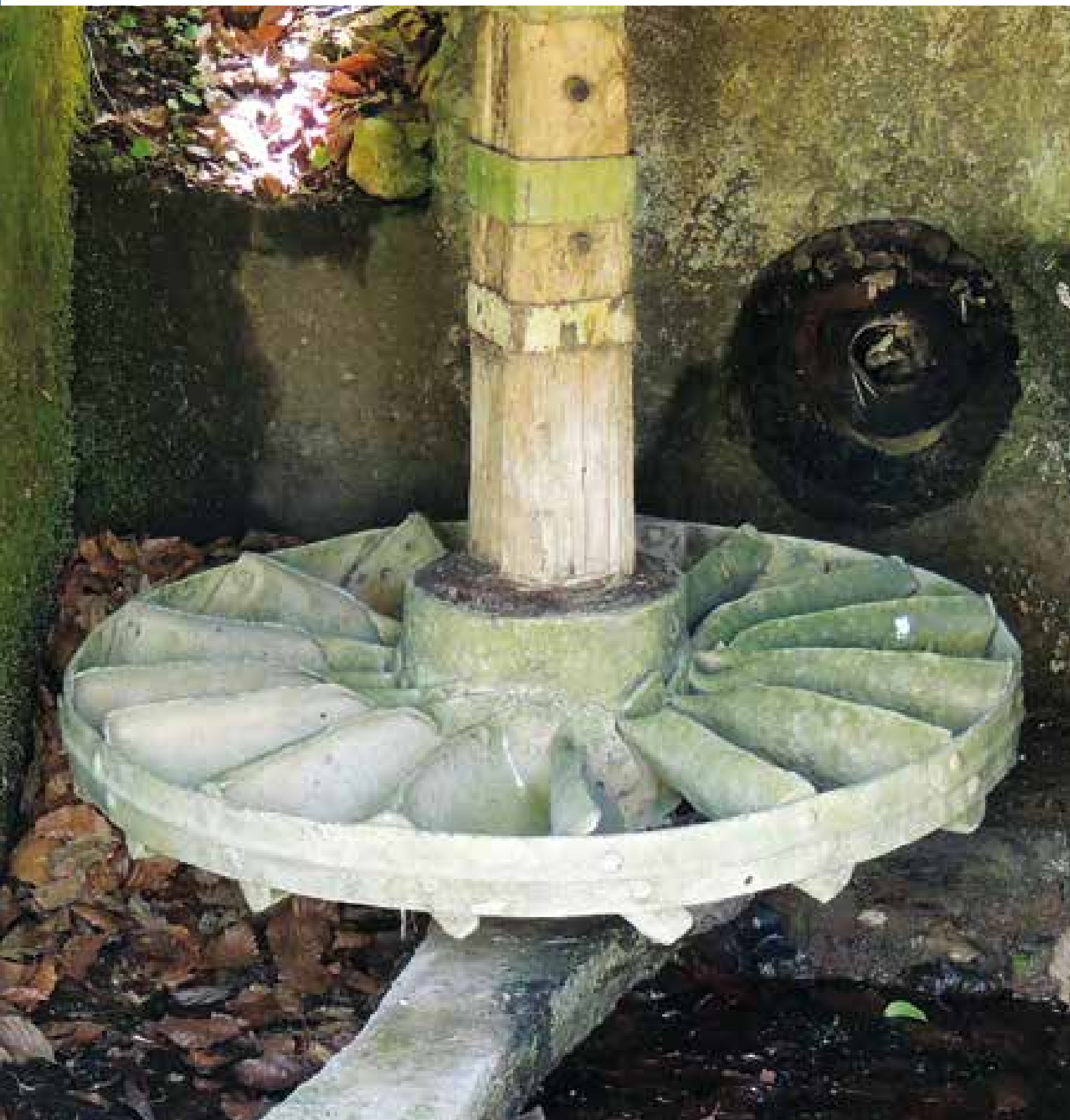
Ožednjelo mlinsko kolo u Potkalinju priželjkuje mlaz bistre pitke vode potoka Kalin. Vreteno – osovina, četvrtasta ili okrugla, prenosi energiju vode od kola ili vitla do mlinskog kamena. Gornjim dijelom prolazi kroz mlinski pod i završava se vezom za gornji žrvanj metalnom polugom koja se zove paprica i tako okreće gornji žrvanj.
