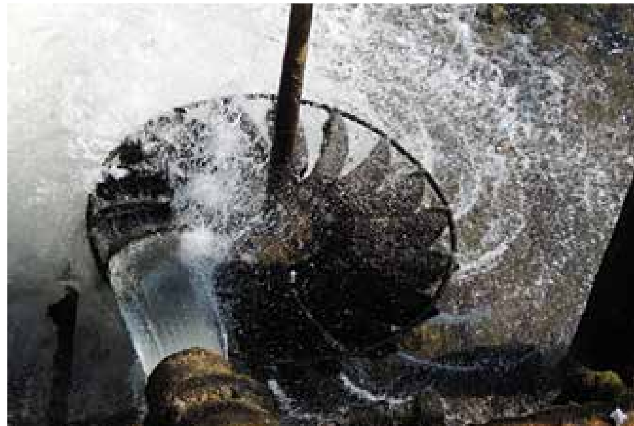
Vodenica je izgrađena na mjestu gdje je više od sto godina bila stara vodenica. Na donjem dijelu svaki badanj se sužava kako bi se dobio mlaz vode potreban za okretanje vitla. U ljetnom periodu, kada je čest manjak vode, koristi se obručac koji se ubacuje u slavinu, kako bi se smanjila količina vode a zadržao mlaz. Na fotografiji se vidi kako voda izlazi kroz slavinu ili cipun u punom kapacitetu.
