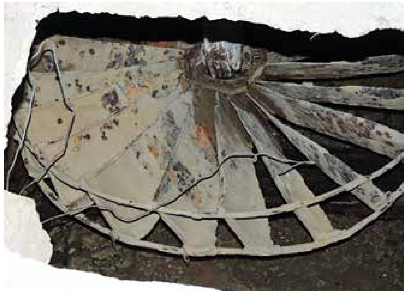
Vitlo koje i danas pokreće žrvanj na jedinoj vodenici Steve Buljevića u Muškovcima.
